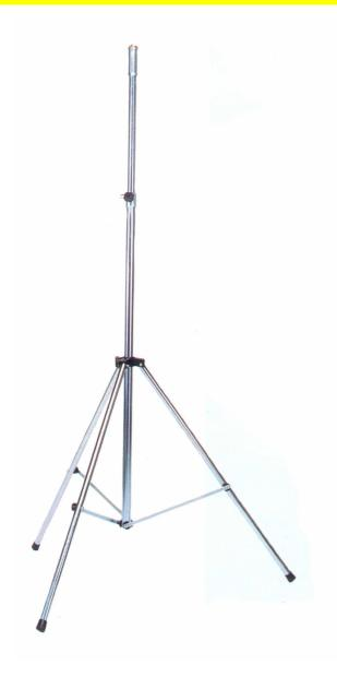
Stativo di supporto base con treppiede, struttura completamente in tubo di acciaio zincato. Regolazione in 1510mm 2510mm altezza / mediante bloccaggio di sicurezza catorcetto manopola M8. е il trasporto la facilitare base richiudibile su se stessa. Piedini in PVC. Peso 6,20kg. Portata 40kg. completo di adattatore per fissaggio apparecchiature, composto da tubo di lungh. 90mm, acciaio manopola laterale di blocco al tubolare dello stativo.
