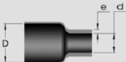
**Nota:** Avendo a disposizione il diametro dell'oggetto da ricoprire, la larghezza della guaina appiattita si può determinare con la formula  $1,57079 \times \text{diametro}$ .
