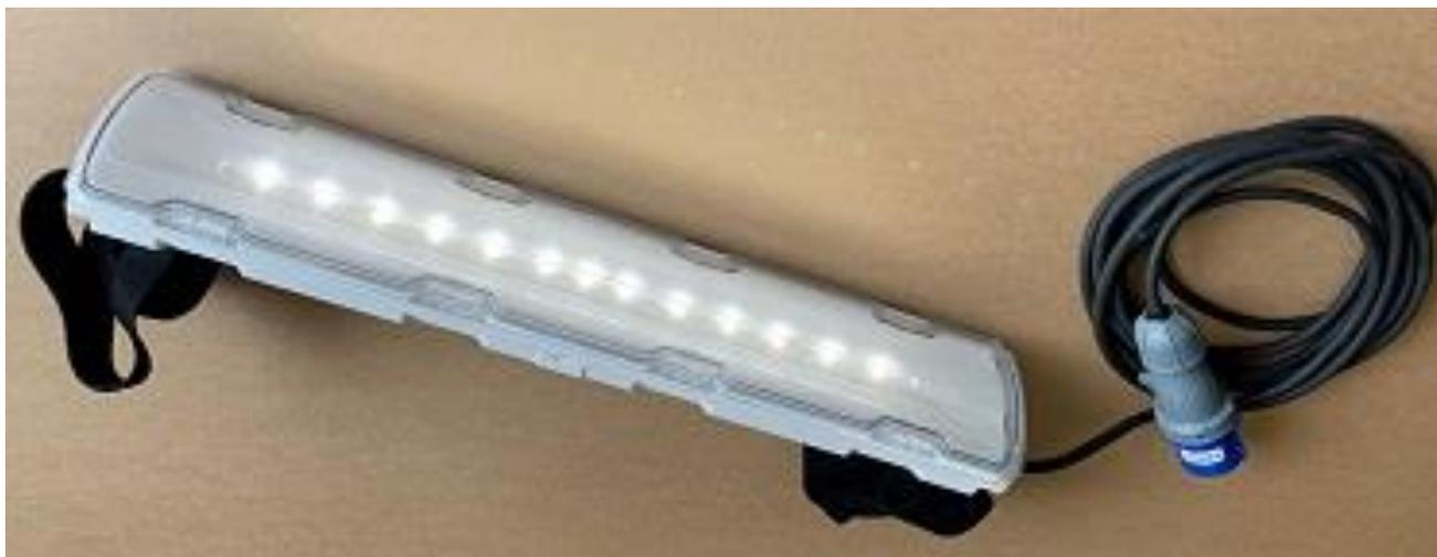
Completa in alimentazione di 5 metri cavo H07 RN-F 2 x1,5 mm<sup>2</sup> e spina mobile CEE P17 16A 230V 1P + N + T 6h grado di protezione IP44 (Norme IEC 529, CEI 70-1 e EN 60529) realizzata in materiale termoplastico ad elevate caratteristiche di resistenza all'urto ed a elevata stabilità dimensionale, velcri back to back per il fissaggio in tenda alla paleria o alle arcate, interruttore ON /OFF per la sistemazione in magazzino
