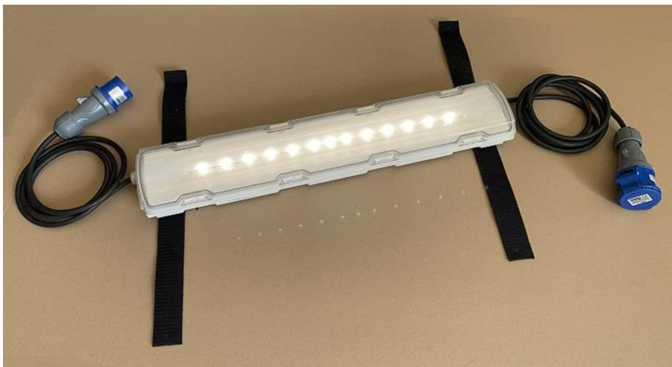
Versione con alimentazione passante, completa spina e presa mobile CEE P17 16A 230V 1P + N + T 6h grado di protezione IP44 (Norme IEC 529, CEI 70-1 e EN 60529) realizzate in materiale termoplastico ad elevate caratteristiche di resistenza all'urto ed a elevata stabilità dimensionale, 2,5 metri cavo H07 RN-F 2 x1,5 mm<sup>2</sup> per lato e velcri back to back per il fissaggio in tenda alla paleria o alle arcate, interruttore ON /OFF per la sistemazione in magazzino
