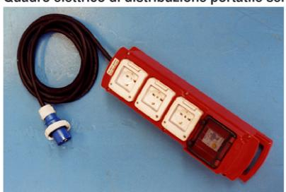
Contenitore stampato iniezione in policarbonato, colore rosso nero, totale 0 а isolamento, autoestinguente, leggero, ottima resistenza meccanica ed all'invecchiamento. Viti di fissaggio del coperchio in acciaio INOX. Dimensioni 450 x 105 x 120 mm.(L x H x I). Sportello in infrangibile policarbonato trasparente con chiusura a mezzo due viti di blocco e con molla di ritorno in acciaio INOX e guarnizione di tenuta a garanzia
