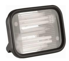
Lampada fluorescente 2 x 18W. Diffusore in policarbonato. Custodia in materiale isolante ad altisssssima resistenza meccanica. Staffa posteriore per il supporto e l'aggancio. n° 2 strisce di velcro per il fissaggio e posizionamento. Sorgente luminosa n°2 tubi fluorescenti ognuno 18W PHILIPS PL-L. Classe I. Grado di protezione IP54 In alimentazione 5 metri cavo flessibile H05 RN-F 2 x 1 mmq e spina volante schuko, completa di n°1 presa schuko UNEL16A2P+T.
