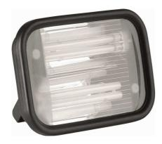
Lampada fluorescente 2 x 18W. Diffusore in policarbonato. Custodia in materiale isolante ad altisssssima resistenza meccanica. Staffa posteriore per il supporto e l'aggancio. n° 2 strisce di velcro per il fissaggio e posizionamento. Sorgente luminosa n°2 tubi fluorescenti ognuno 18W PHILIPS PL-L. Classe I. Grado di protezione IP54 In alimentazione 5 metri cavo flessibile H05 RN-F 2 x 1 mmq e spina volante schuko, completa di n°1 presa schuko UNEL16A2P+T.
