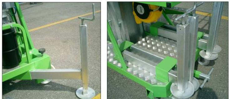
**Stabilizzatori in acciaio con manovella e loro sede sul telaio**
