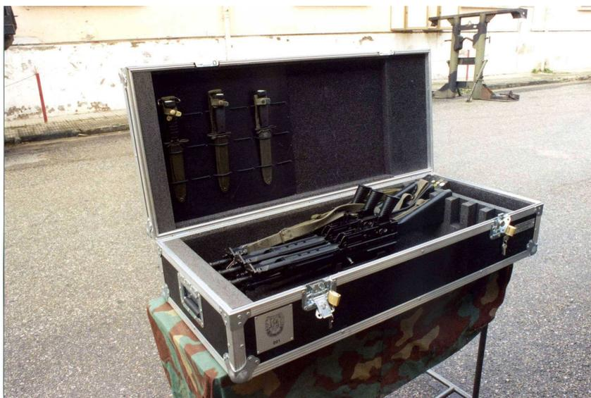
Robusta struttura realizzata in multistrato fenolico in legno da esterno spessore 10 mm  $\pm$ 10%. Rivestimento esterno in laminato plastico, colore verde militare, spessore 1 mm  $\pm$ 10%. Rivestimento interno in materiale, ammortizzante gli urti, spessore 10 mm  $\pm$ 10%. Profili in alluminio a doppio incastro di protezione e rinforzo degli spigoli con otto cantonali in acciaio, fissati tramite rivetti, che permettono la sovrapposibilità
