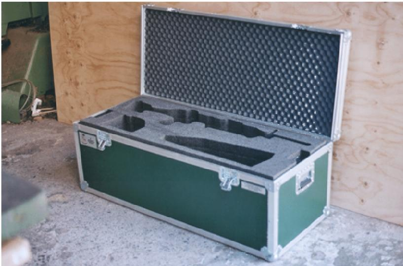
Robusta struttura realizzata in multistrato fenolico in legno da esterno spessore 10 mm  $\pm$ 10%. Rivestimento esterno in laminato plastico, colore verde militare, spessore 1 mm  $\pm$ 10%. Rivestimento interno in materiale, ammortizzante gli urti, spessore 10 mm  $\pm$ 10%. Profili in alluminio a doppio incastro per protezione e rinforzo sugli spigoli mediante otto cantonali in
