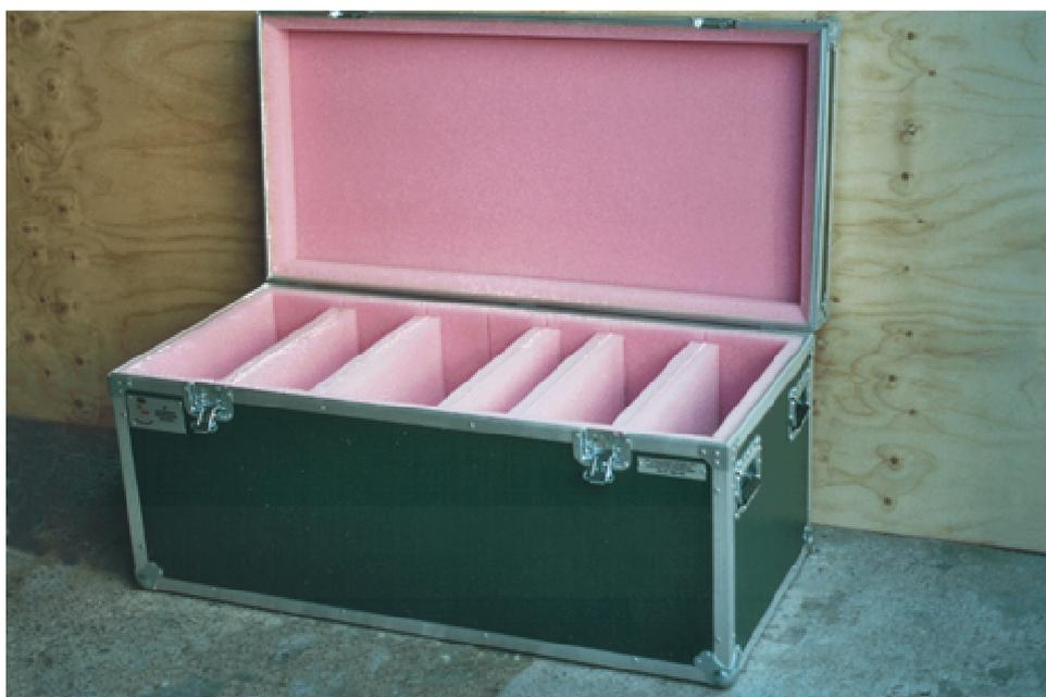
Robusta struttura realizzata in multistrato fenolico in legno da esterno spessore 10 mm  $\pm 10\%$ . Rivestimento esterno in laminato plastico, colore verde militare, spessore 1 mm  $\pm 10\%$ . Rivestimento interno in materiale, ammortizzante gli urti, spessore 10 mm  $\pm 10\%$ . Profili in alluminio a doppio incastro per protezione e rinforzo sugli spigoli mediante
